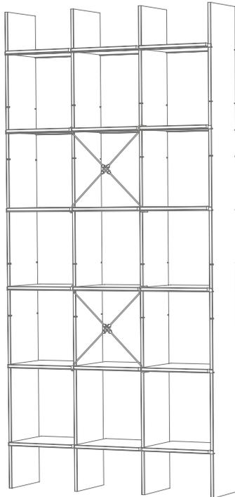
FNP Fix stabilisiert freistehende Regale, realisiert Tür-Überbauten und ähnliche (auch freistehende) Brückenkonstruktionen. Kann nur an Innenfächern montiert werden.
