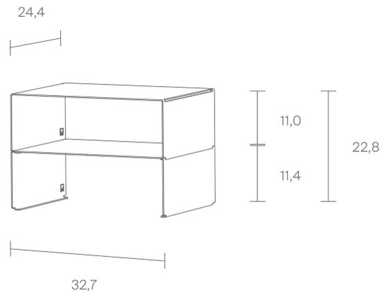
FNP Facheinteilungen aus Aluminium werden flach geliefert und von Hand in Form gebogen. Eine Verpackungseinheit umfasst zwei Stück, die nach dem Biegevorgang ineinander gesteckt werden. In das FNP-Fach eingefügt, ergibt sich eine zusätzliche Unterteilung des Fachs.
